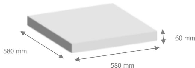
Les dalles béton Kwadrato d'Interblocs sont lisses (chanfrein limité à 2/2 mm). D'autres finitions sont envisageables. Elles sont hydrofugées dans la masse.
