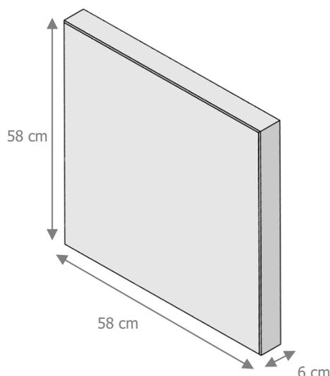
Les palissades béton d'Interblocs sont lisses (chanfrein limité à 2/2 mm). D'autres finitions sont envisageables. Elles sont hydrofugées dans la masse.
