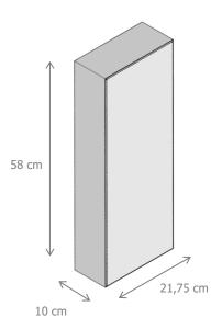
Les palissades d'Interblocs sont lisses (chanfrein limité à 2/2 mm). D'autres finitions sont envisageables. Elles sont hydrofugées dans la masse.
